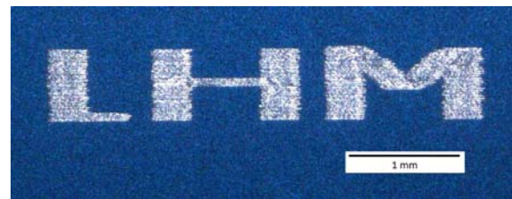
Abb.1: Schriftzug auf Silizium, P = 200 W, Linienabstand 25 \mu\text{m}
