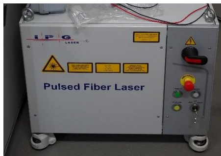
Abb. 1: ns-Burst-Laser von IPG Laser GmbH mit einer Leistung von 6 kW im Burst, mittlere Leistung 3 kW.
