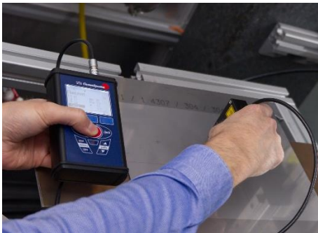
Abb. 3: Messprozess zur organischen Verunreinigung mit SITA Clean Spector.
